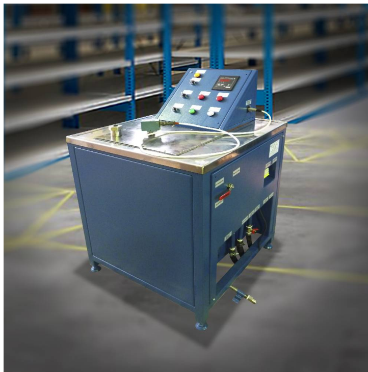
Стенд для испытания и настройки датчиков-реле температуры ТММ-103
