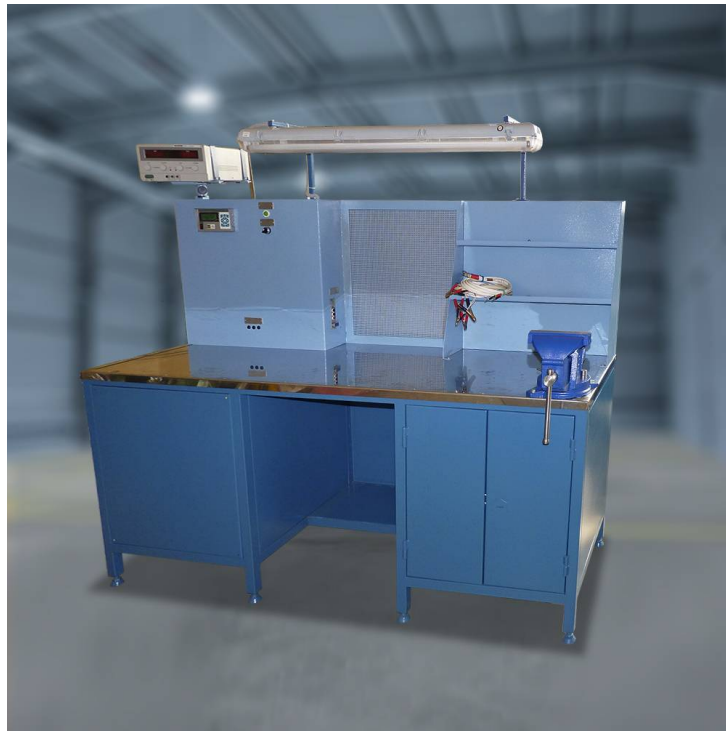
Специализированное рабочее место контроля электромагнитных контакторов (СРМ-АЦ МК)
